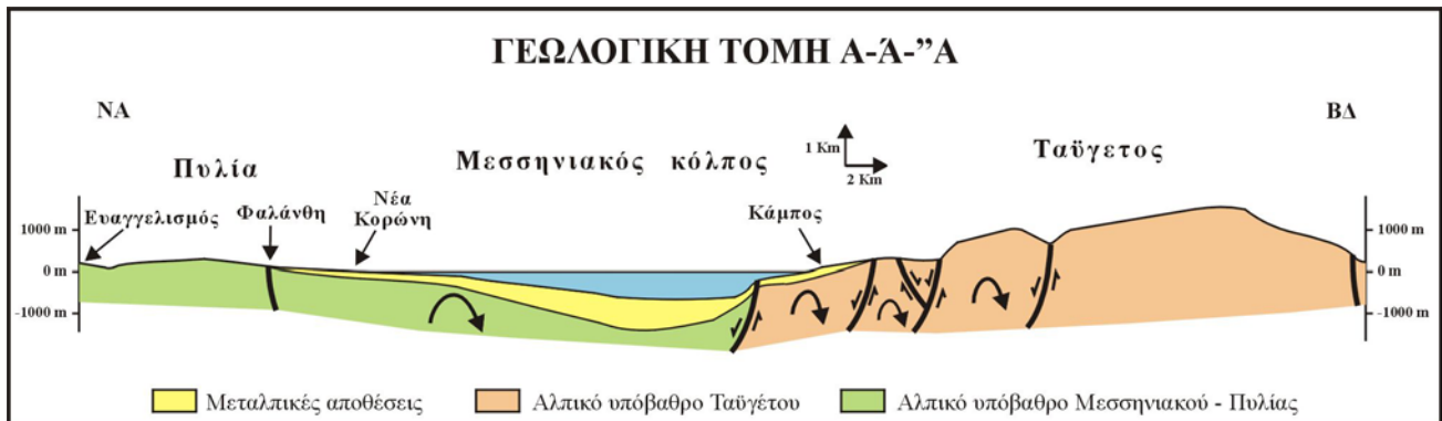
Εικ. 4: Σχηματική τομή A-A'-A'' κατά μήκος του Μεσσηνιακού κόλπου και του Ταΰγετου. 1:Μεταλλικά ιζήματα, 2:Προνεογενές υπόβαθρο.
